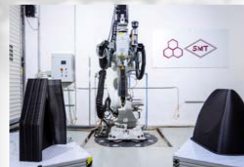
robotergestützter Zwillingsdruck mit der twinform®-Technologie
