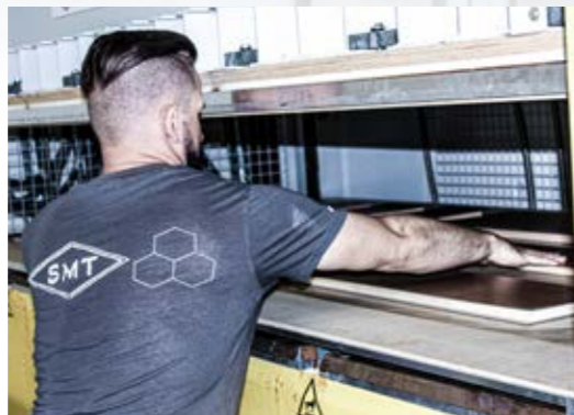
Verpressen der Holzplatten mit dem Dekor
